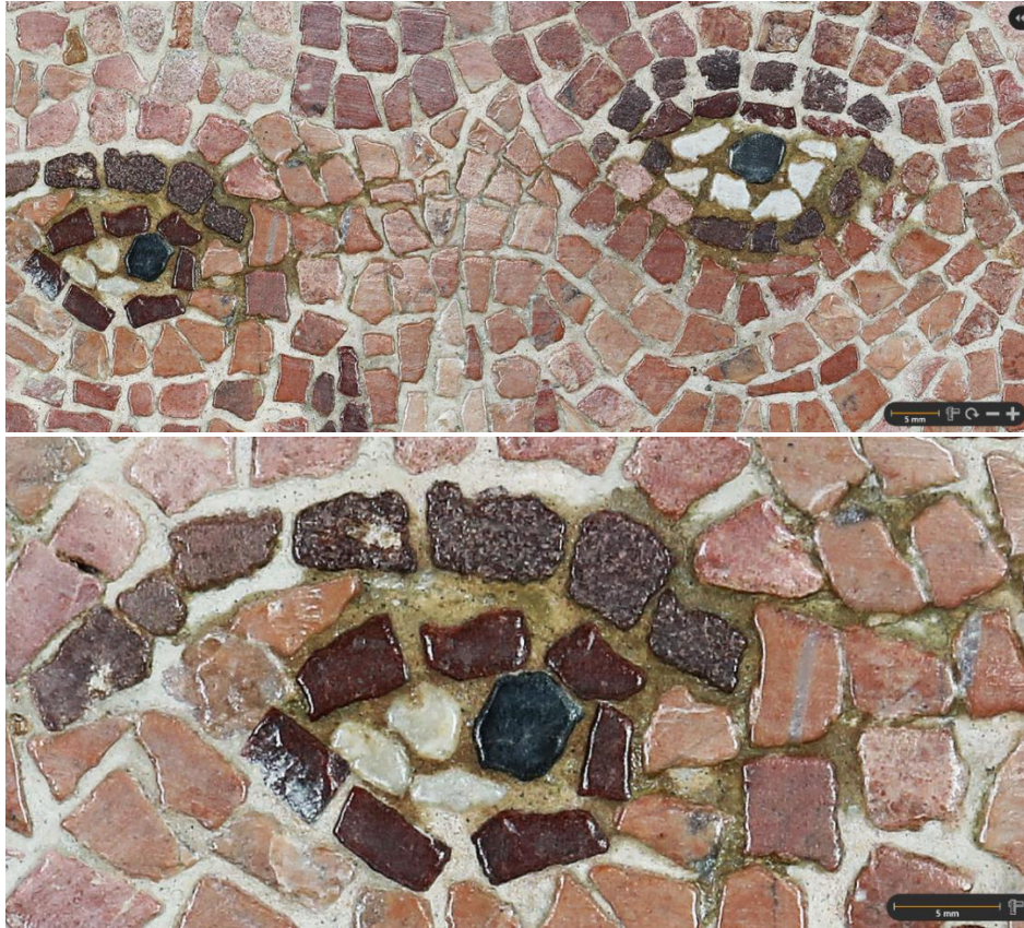
Fig. 10. Manchas en el mortero de unión de teselas en la zona de los ojos
